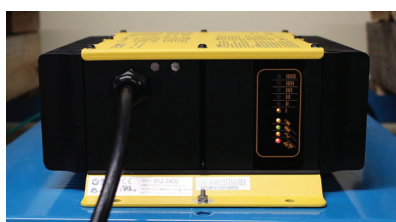
図4: 充電器LEDインジケータのセルフテスト。
