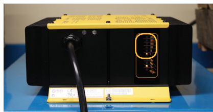
図5: 電流計上の充電プロファイル番号1。
